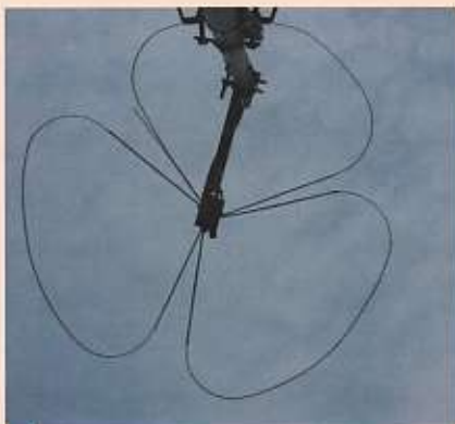
Deze klaverbladantenne is ontworpen voor 2m maar werkt ook uitstekend voor het 70cm bakken. De twee bakens voor 2m en 70cm zenden uit met een horizontale polarisatie.
